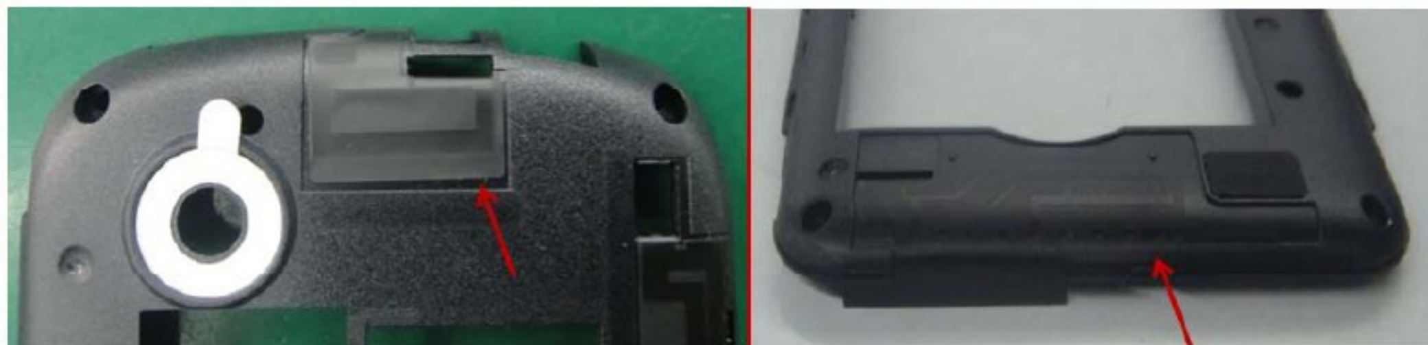
容易起翘的边角部位点460胶水，抹3367处理剂
