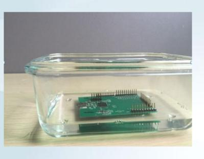
优点:操作简单,无须增加设备投入,无须真空环境,涂布均匀,只需要将PCBA在纳米防水液中浸泡几秒就可以,做完涂层后并不影响连接器的导电性,可以防酸碱盐腐蚀,因为直接涂布在PCB板上,产品外观的变形损伤不会对PCB形成明显的影响,由于是基于PCBA浸泡涂布的,所以几乎适用于所有电子产品,对各种基材的PCB板附着力都比较好,并且对PCBA本身不损害。缺点:目前还无法单靠PCB纳米涂层做到7级以上防水,只适用干生活防水
