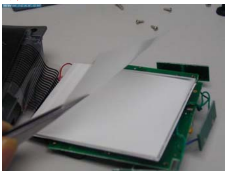
导光 板靠 LCD 面的磨沙玻璃纸
