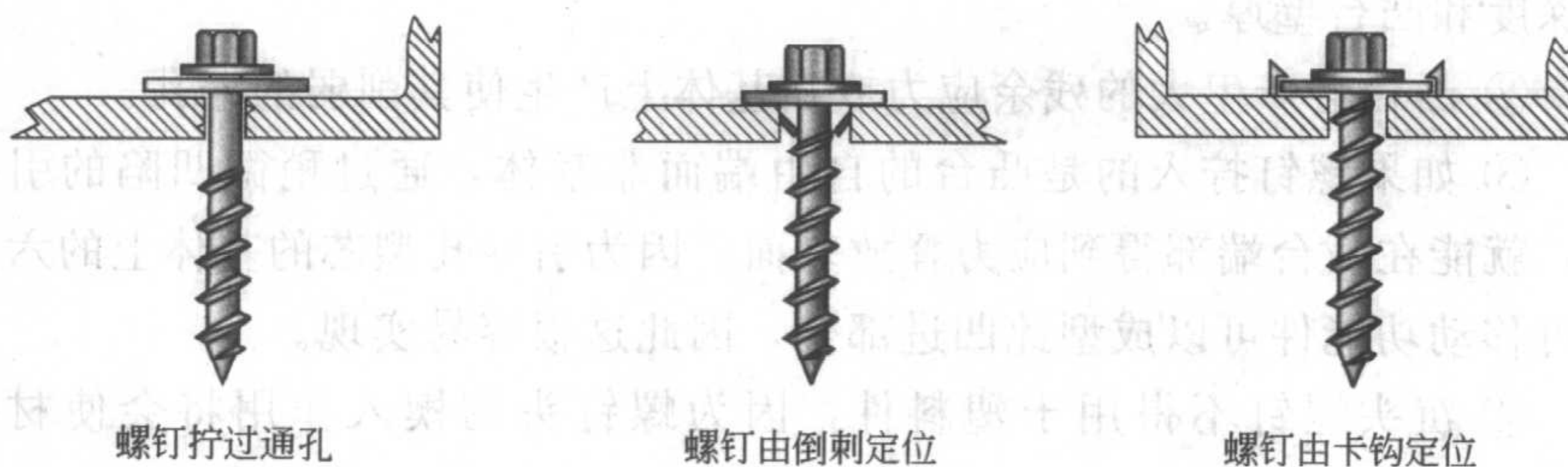
图 7.13 螺纹紧固件预装在塑件上
