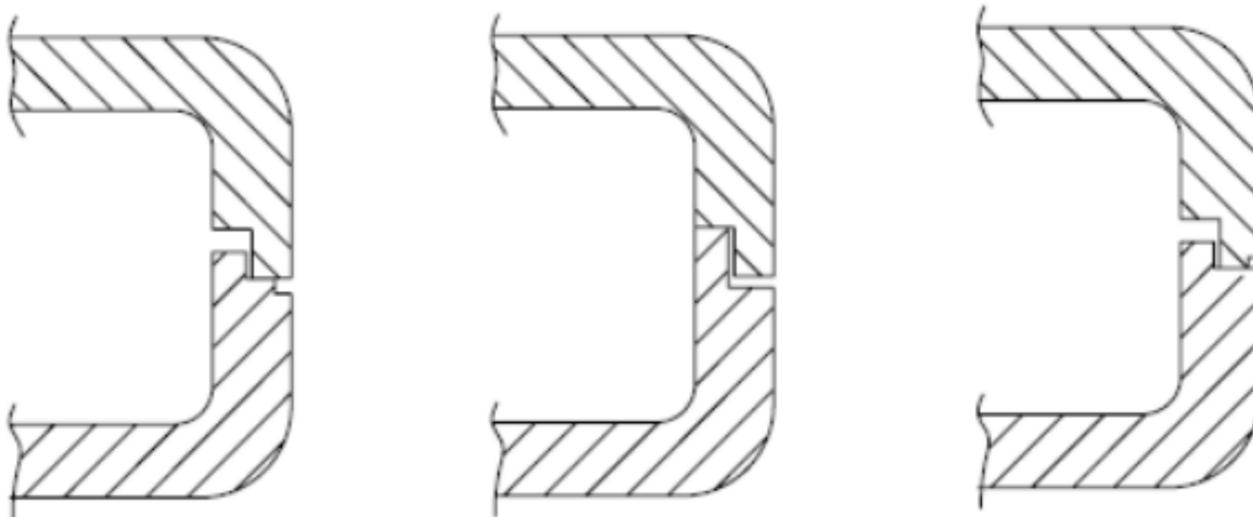
塑胶零件止口的常见形式及间隙取法
