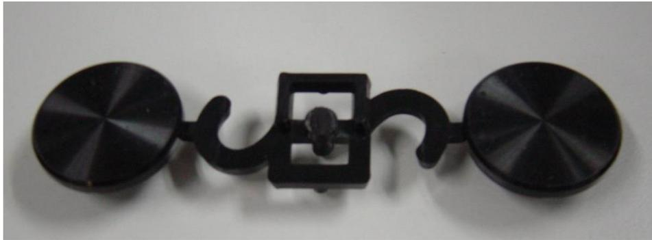
另外最好不要在塑件中有金属嵌件存在，由于两者的膨胀系数不同，在温度升高时，电镀液体会渗到缝隙中，对塑件结构造成一定的影响。
