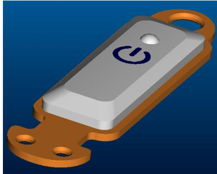
4 多功能按键一般会采取电镀的表面处理工艺，由于水电度是导电的，所以，为了有效防止 ESD 试验失败，裙边部分需要阻镀，办法是裙边部分涂阻镀油墨（一种不导电的液体），但由于阻镀油墨都是蓝绿色的，所以阻镀后裙边的颜色都会变成蓝绿色。如下图所示：
