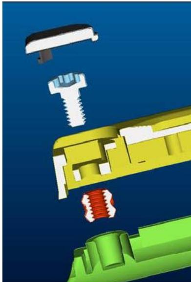
图 28：螺钉螺母装配结构示意图（Explode）
